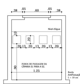
CORTE 2 - TANQUE SÉPTICO
