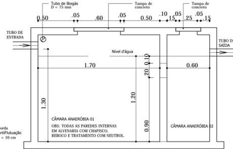
CORTE 1 - TANQUE SÉPTICO
