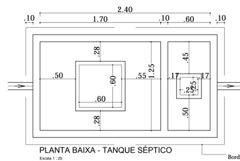
PLANTA BAIXA - TANQUE SÉPTICO
