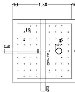
FILTRO ANAERÓBIO PLANTA BAIXA - ESC. 1:25
